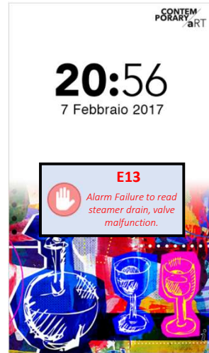
ESEMPIO DI ALLARME
