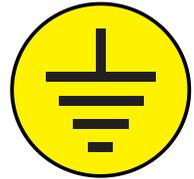
Le four doit être inclus dans un système équipotentiel et connecté à un conducteur ayant un calibre de fil minimum de 10 mm<sup>2</sup>, connecté à la borne située à l'arrière du four portant le symbole approprié.
