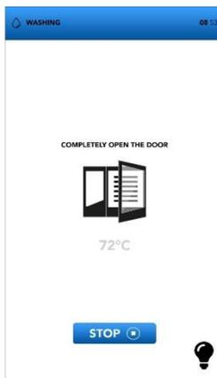
5 Raggiunta la temperatura di sicurezza il display indica di chiudere la porta precedentemente aperta (il successivo avvio del lavaggio avviene automaticamente)
